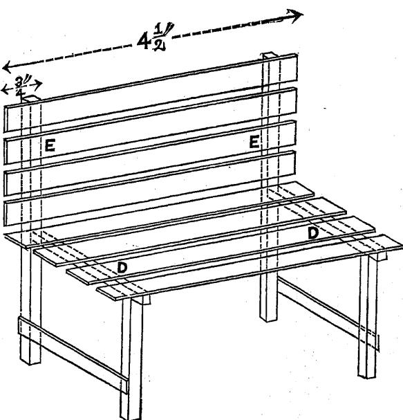
く同じ間隔で付けるのである、其の時注意せねばならぬのは支へ木が腰掛け板の端から $\frac{3}{4}$ "だけ離つて居なければならぬ事である。それから残りの四
