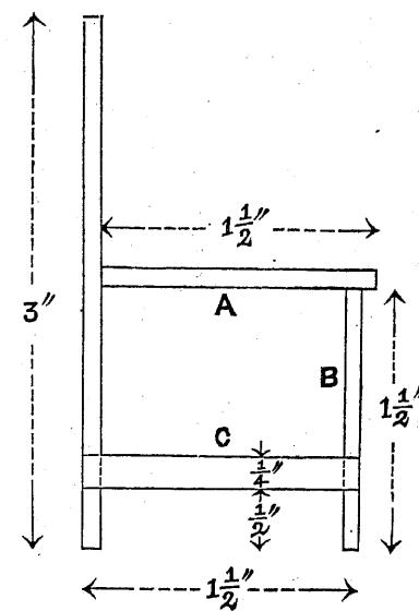
$1\frac{1}{2}$ "のを四本作りて前脚及び支へ木としてA Bの如く組み立てる。そこで前、後脚を固定させる爲めに平板、を長 $1\frac{1}{2}$ "幅 $\frac{3}{4}$ "に裁ちたるものを作り二板作
