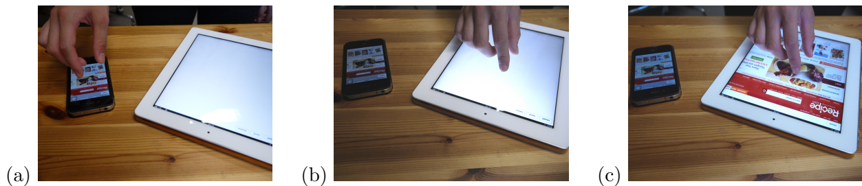
図 1. 本方式による複数コンピュータ間コピー・アンド・ペースト. (a) 複数指で情報をつまみ上げ, (b) 別のコンピュータに移動, (c) 画面に置く.
