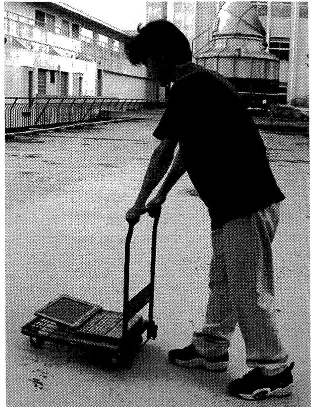
図1. Virtual Glassboat. カートに搭載されたコンピュータ画面が、移動方向と逆にスクロールする。
