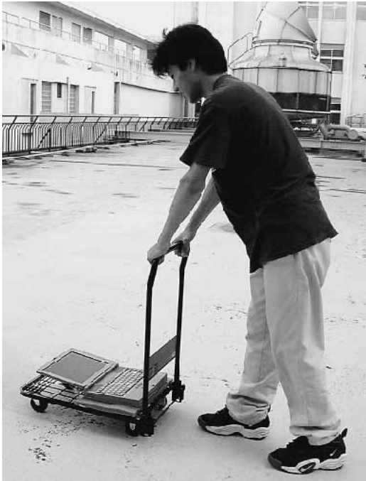
図 15 Virtual Glassboat . カートに搭載されたコンピュータ画面が、移動方向と逆にスクロールする .
