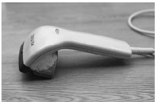
図2 FieldMouse の例．光学式マウスの内部にバーコードリーダーを組み込んだ．
