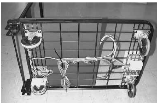
図 16 カートの底面 . 後輪 (左) の回転を測定する . また先頭部分 (右) には RFID リーダが取り付けられ、床の上の ID 板を読みとる .
