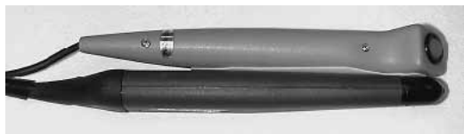
図1 FieldMouse の例．機械式ペンマウスとバーコードリーダーの組み合わせ．
