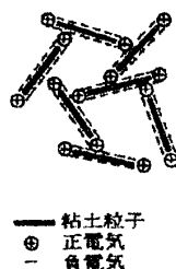
図6 粘土粒子のカードハウス構造 1)
