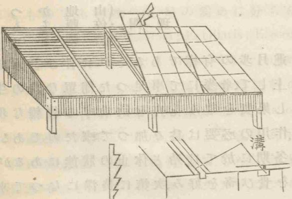
は溝をつけて降雨の節合せの目の隙間より漏れる水の流出路に備へて置くのである。そして上部には四枚の障子をかけて全面を覆ふ。この障子一枚は幅三尺長さ四尺餘で縦に二條の支材をつけ板硝子を嵌める、硝子のかさなりは三四分位としそのところに亞鉛板の小片俗に「イナヅマ」と云ふのを狭んで硝子板の密着を防ぐのである、若し板硝子を密着させると毛細管引力が強くなつて水滴が必ずその間に進入したとへ日光があたつても、蒸發乾燥することなく、光線の透射を弱くし、遂には水滴が内部に滴下して、禍の源となるからである。さて此の準備はバテと親しみ
