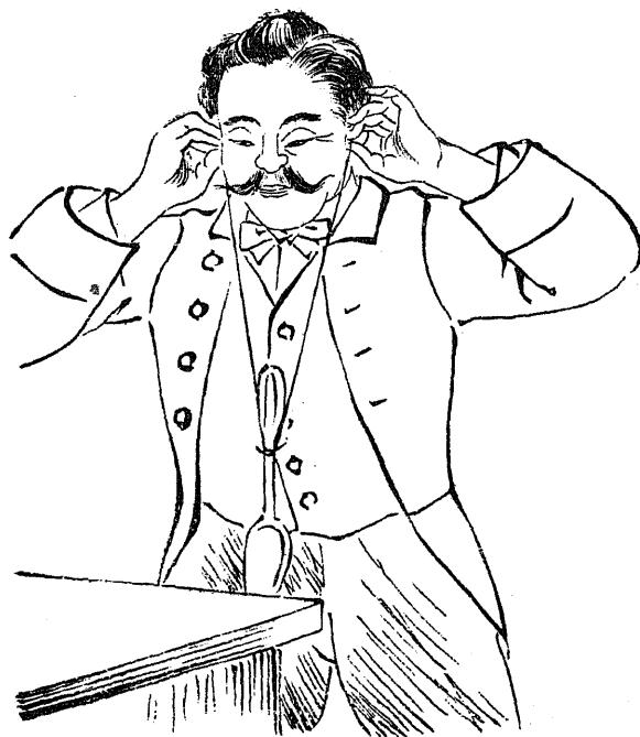
にあて、匙を真中に吊し之を動搖ながら、机の様などに突き當らすれば、匙の振動は、糸を傳はりて耳に達し、匙の衝突する毎にゴーン／＼といふ音がして、お寺の梵鐘を聞くを得べし。次は
