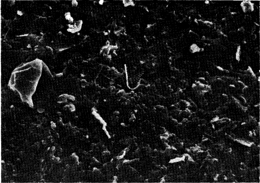
写真4. 泥皮の走査型電子顕微鏡写真 (富竹泥皮内側面, \times 2,000 )
