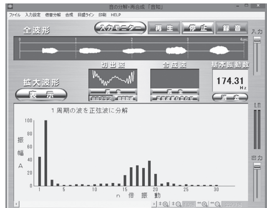
図3 「い」の正弦波の倍音強度グラフ
