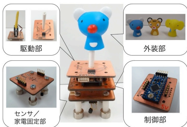
図 2 Kadebo のプロトタイプの外観：外装部，駆動部，制御部，センサ／家電固定部から構成される。
