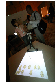
図 1 バーチャルな情報を投影する掃除機。 Fig. 1 Vacuum cleaner projecting images on the floor.
