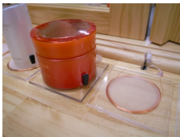
図 4. RFID アンテナと RFID タグをつけた化粧品。
