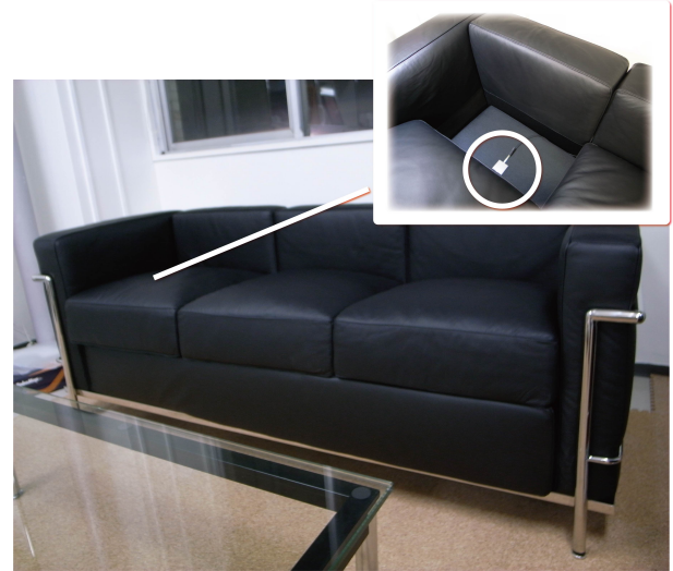
図 5: ソファーマットの下，3 か所に圧力センサを取り付けた
