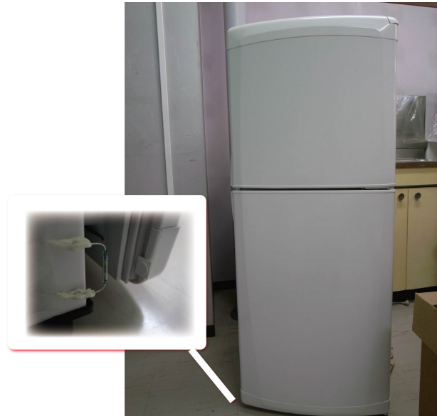
図 7: 冷蔵庫の扉にリードスイッチを取り付けた
