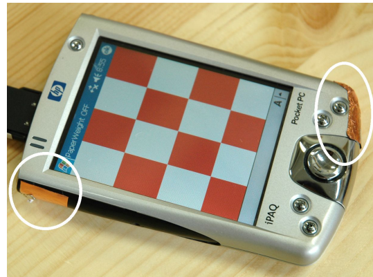
図7. 利き手(右手)の手のひらが当たる部分(左円内)と、非利き手(左手)の親指があたる部分(左円内)にタッチセンサをつけた試作機。評価実験用プログラムが動作している。
