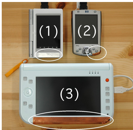
図 2. 文鎮メタファーのためのセンサを実装した 3 種類の試作機．丸印で示したタッチセンサ電極を, (1)(3) は画面下部中央に設置し, (2) は右下部に設置した．
