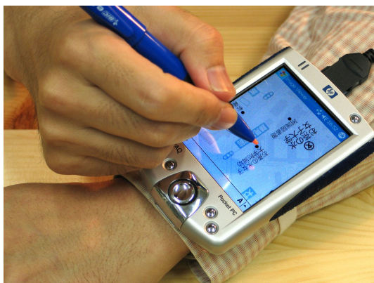
図 6. 腕装着型ウェアラブルコンピュータへの応用．文鎮メタファーは片手操作が必須の状況で効果的である．
