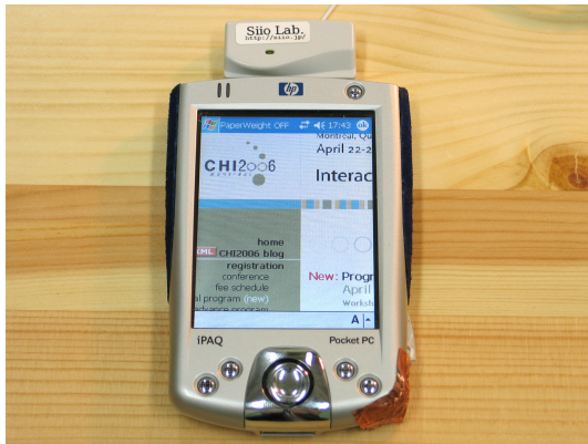
図 4. 文鎮メタファーによるスクロールモード切替えを実装した WWW ブラウザ。
