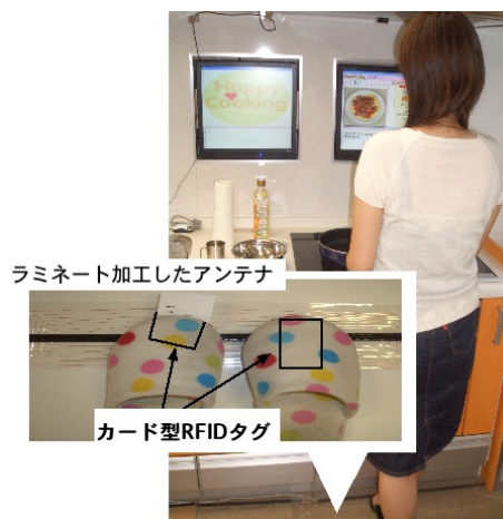
図3 多機能フットスイッチを組み合わせた調理支援システムと、アンテナの拡大図(スリッパからはみ出しているのが RFID タグ)
