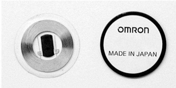
図1. 本研究で使用したRFIDタグ(右)とその内部(左)。直径23mm, 厚さ1.2mmの円盤型。
