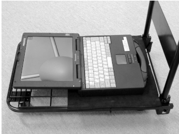
図8. Virtual Glassboat. カートに搭載されたコンピュータ画面が、移動方向と逆にスクロールする。
