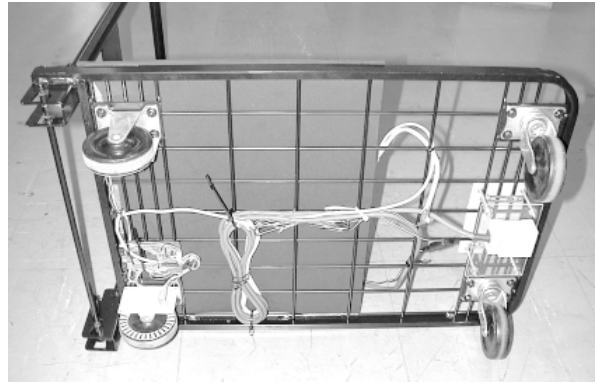
図9 カートの底面。後輪 (左) の回転を測定する。また先頭部分 (右) にはRFIDリーダが取り付けられ、床の上のRFIDタグを読みとる。
