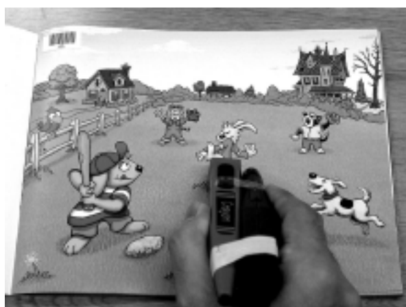
図5. Active Bookの試作例。Absolute Mouseでページ左上に貼られたバーコードを読み取った後、絵本の人物の上に移動すると、台詞が音声で再生される。バーコードにはページを特定する情報が記録されている。
