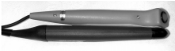
図1. Absolute Mouse の例。ペン型マウスとバーコードリーダーを接着した。物の表面に貼られたバーコードを読み取り、これを原点とした二次元位置を検出する。
