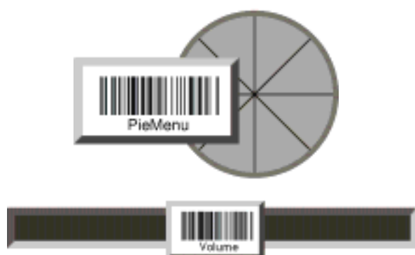
図9. バーコードを読み取った後の移動により操作する、Pie Menu (上)とスライダー(下)の例。
