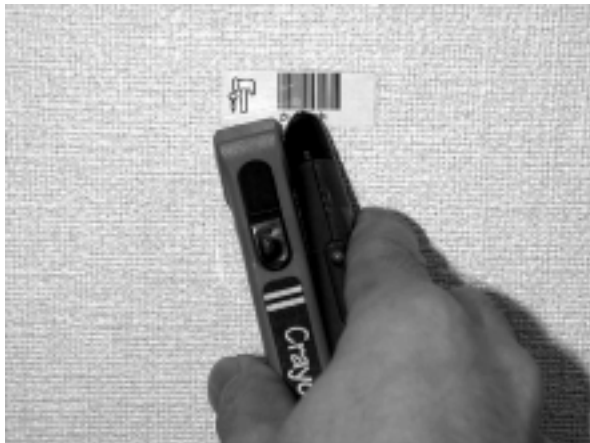
図2. Absolute Mouse の使用例。ここでは壁に貼られたバーコードを読み取っている。この後、平面に接触したまま移動することで、バーコードを原点とした二次元位置を検出できる。
