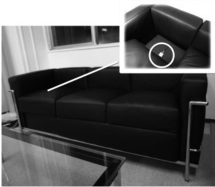
図 6 ソファーマットの下、3 か所に圧力センサを取り付けた
