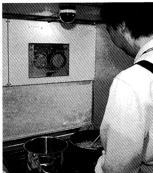
図4 調理を記録している様子。フットスイッチの操作で、上方のカメラを使って手元の写真を撮影し、音声メモを記録する。
