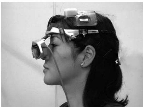
図4 頭部に装着した透過型 HMD とジャイロセンサ。
