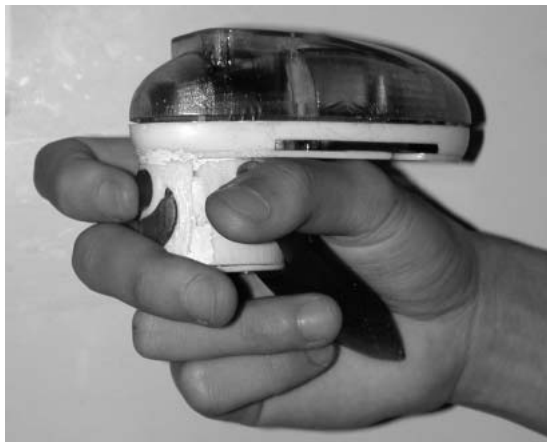
図3 描画を行うペンデバイス。ジャイロセンサによるマウス機構を内蔵している。
