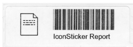
図1. IconStickerの例。アイコンの図柄、名前、バーコードが28 x 89 mmのラベル用紙に印刷される。アイコンの図柄が印刷されるので、画面の中のアイコンとの対応が容易である。バーコード部分には、コンピュータ内のアイコンへのポインター情報が記録されている。
