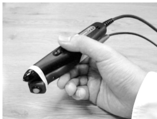
図6. 試作機では、バーコードリーダーとメカニカルマウスが組み合わされたペン型デバイスを用いた。
