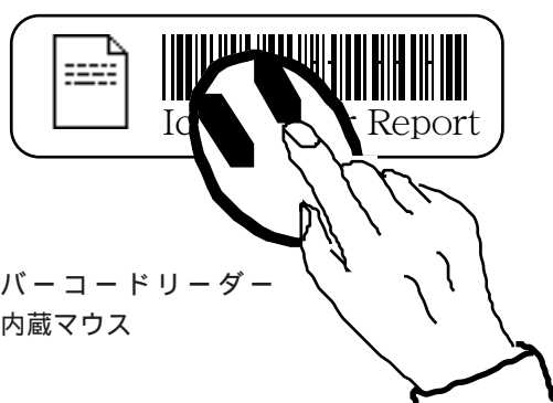
図5. IconStickerのバーコード部分を読み取ると、元のアイコンがコンピュータディスプレイ内で開く。
