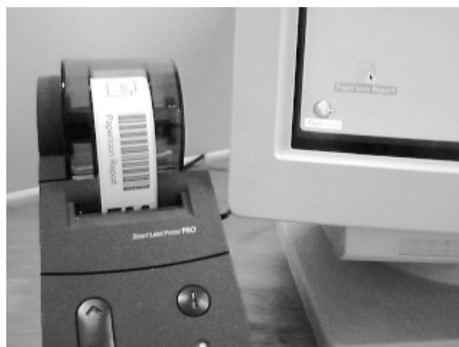
図3. 画面内のアイコンを、「実世界への出口」アイコンにドラッグ&ドロップすると、このアイコンに対応する IconSticker が印刷される。 図4. IconSticker は、ディスプレイ脇に置かれたラベルプリンタで印刷される。
