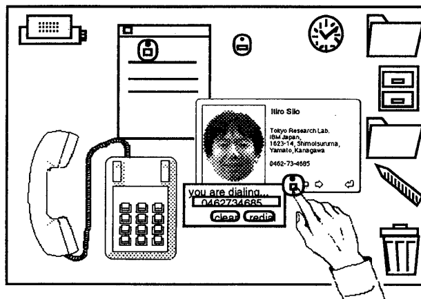
図3 仮想オブジェクトを開いてウインドウにすると、InfoBinder はポインターモードになり、従来の指示装置と同様に直接操作出来る。
