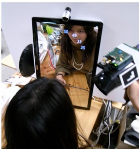
図3：プロトタイプの利用例：ディスプレイとハーフミラーを組み合わせて、髪の毛の周囲に温度情報を提示する。
