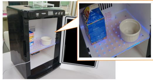
図 4. LED を用いた情報提示の様子。各 LED が異なる周期で点灯する。
