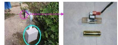
図2 実測用小型メータと電源BOX
